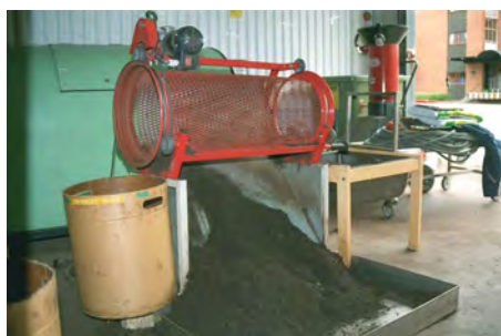
Bioréacteur de petite taille utilisé pour le compostage accéléré dans des restaurants collectifs en Suède [doc. COSTIC]
