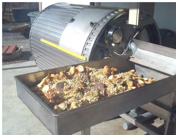
Alimentation d'un bioréacteur de compostage de petite taille [doc. COSTIC]
